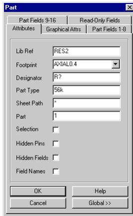
Der *Footprint* verkörpert die Layoutinformation für das PCB. Falsche Footprints werden weder vom Schema-Editor noch vom Netzlistengenerator erkannt. Erst beim Einlesen der Netzliste in das PCB erfolgen entsprechende Fehlermeldungen. Die Footprints müssen aus dem PCB-Bauteilekatalog bestimmt werden.
