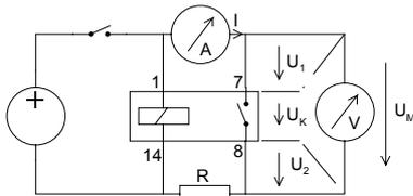
Die Leiterwiderstände für die Spannungsabfälle  $U_1$  und  $U_2$  betragen  $R_{U1}=24\text{m}\Omega$  und  $R_{U2}=22.4\text{m}\Omega$ .
